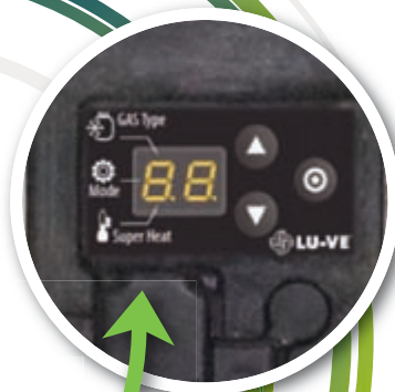
Display para seleccionar los parámetros de trabajo.
