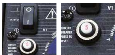
Osolnione przełączniki i wyłącznik ochronny
